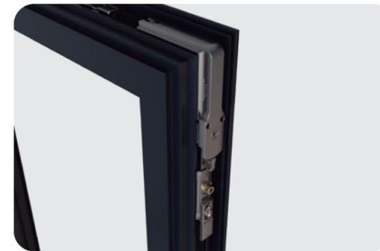
El mecanismo anti-falsa maniobra está integrado en el ángulo de reenvío para reducir las piezas a montar y así queda situado en la parte superior de la ventana conforme sugieren los estándares de seguridad.
