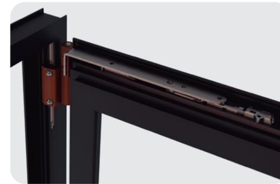
El anclaje de la bisagra superior con compás se ha rediseñado y logrado reducir el tiempo de montaje. Con un gesto queda perfectamente anclada y fija (sin tornillos).
