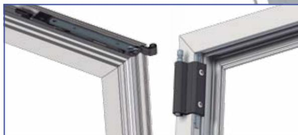
Tanto la bisagra superior como la inferior están diseñadas para un rápido montaje en los perfiles. Se situarán haciendo tope arriba (la superior) y tope abajo (la inferior) facilitando el trabajo al montador, reduciendo los ajustes posibles al máximo. Al ser reversibles, son válidas tanto a izquierdas como a derechas.
